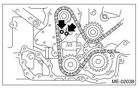
13) Remove the idler sprocket (upper).
